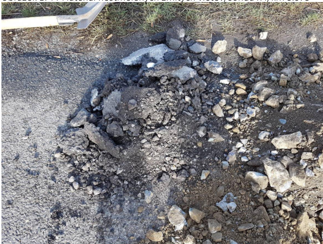
Obrázek B. 11 Materiál nestmelených zrnitých vrstev, sonda K4, km 5.075
