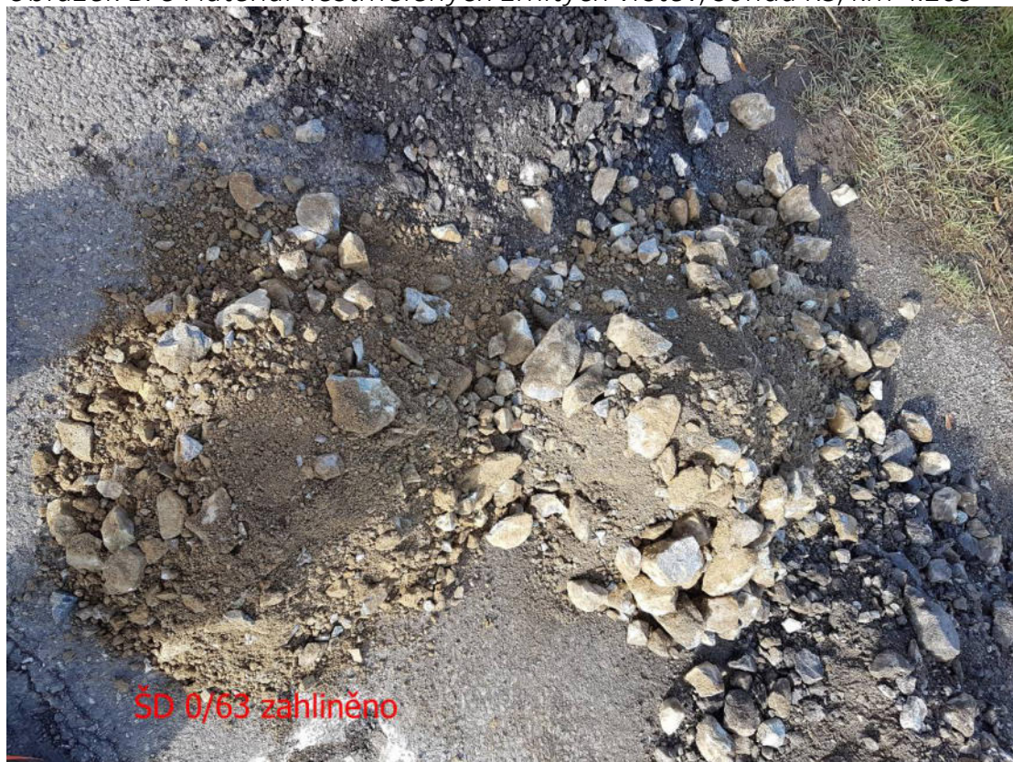
Obrázek B. 8 Materiál nestmelených zrnitých vrstev, sonda K3, km 4.209
