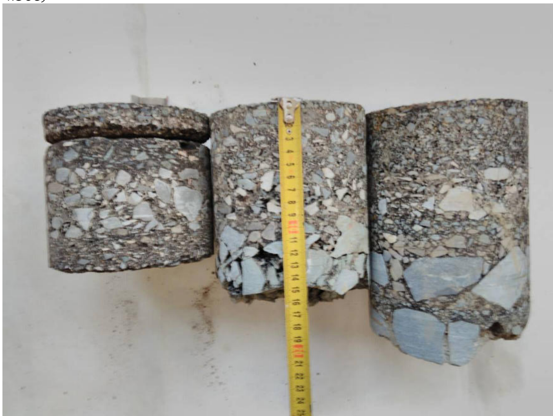
Obrázek D. 4 Vývrt č. 9 (km 2.670), Vývrt č.10 (km 3.050), Vývrt č.11 (km 4.368)
