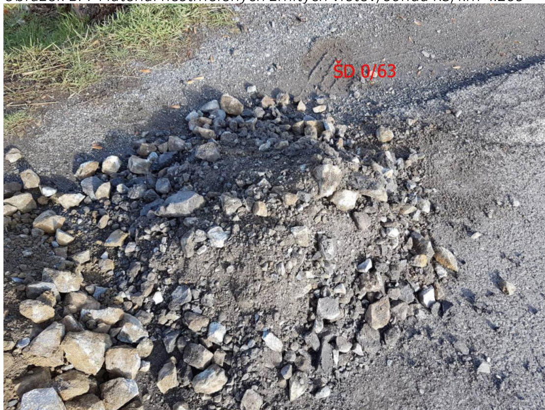
Obrázek B. 8 Materiál nestmelených zrnitých vrstev, sonda K3, km 4.209
